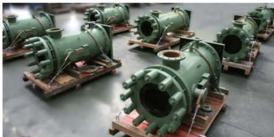
应用于碳钢酸洗线并使用GT-KELITE+ 和TOYO等级石墨的加热器
